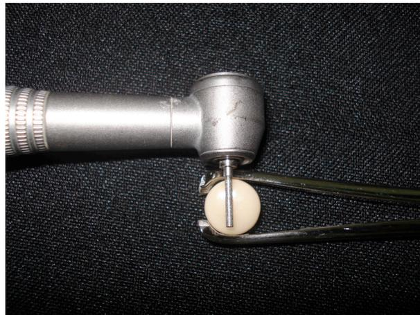
**Figura 4: Corpo-de-prova fixado na pinça Allis**
