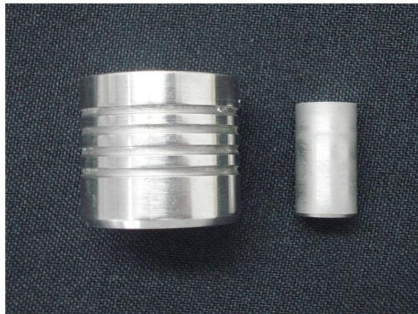
**Figura 1: Matriz cilíndrica de metal polido e êmbolo de metal polido**
