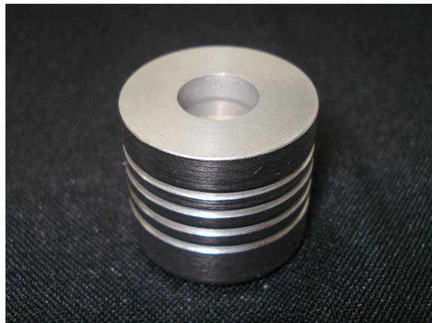
**Figura 2: Matriz cilíndrica de metal polido com o êmbolo encaixado**
