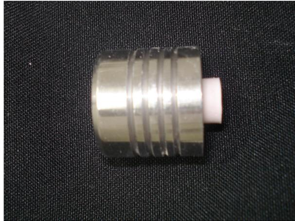
**Figura 3: Remoção dos discos de massa cerâmica por meio de movimentação do êmbolo**
